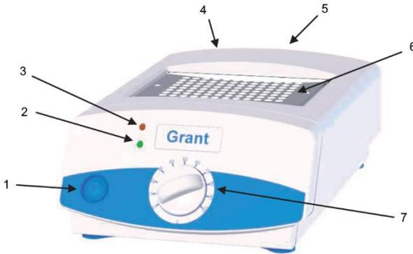
**1. Переключатель питания. 2. Индикатор питания. 3. Индикатор нагрева. 4. Гнездо сетевого кабеля. 5. Экстрактор блоков, в приборе. 6. Съемный блок. 7. Рукоятка управления.**
