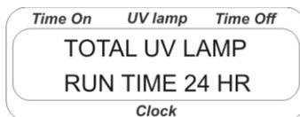
Fig. 5. Affichage en mode de durée de fonctionnement total de la lampe
