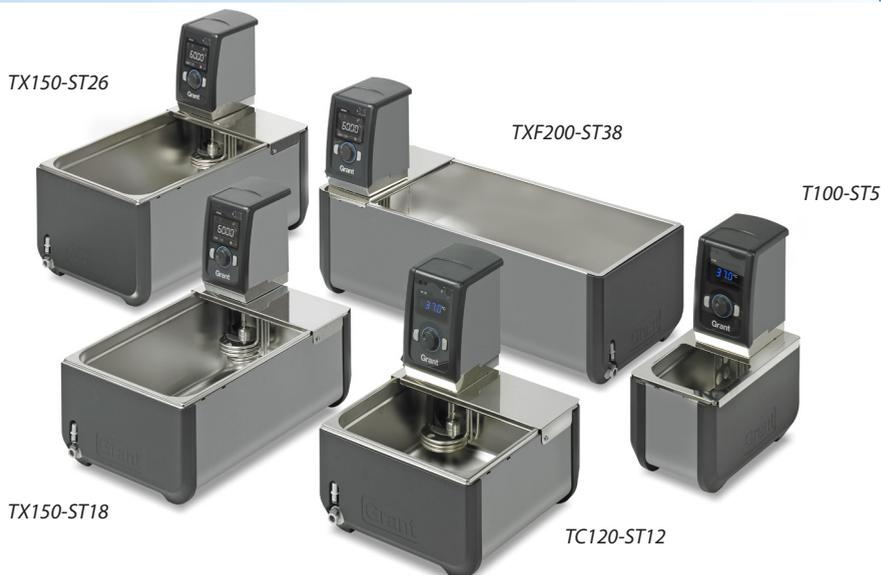
Серия **Grant Optima™** — это multifункциональные и экономически выгодные термостатируемые бани и циркуляторы, сочетающие в себе легендарное качество и надёжность «Grant Instruments». Точный контроль температуры позволяет применять приборы для разных лабораторных нужд.
