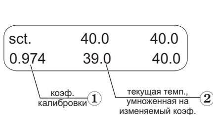
Рис. 3. Панель управления в режиме калибровки
