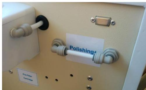
Рисунок 34. Установленная перепускная трубка.
