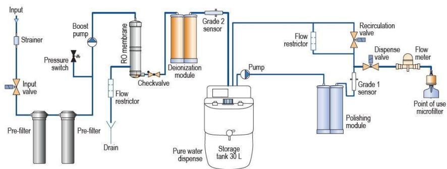
Рисунок 2. Схема модели Labaque Trace
