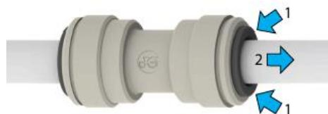
Рисунок 7. Отсоединение трубок
