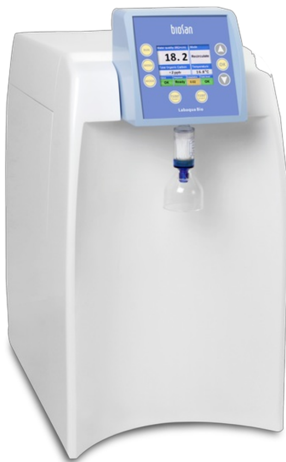
Labaqua Bio Réservoir de stockage de 30 litres système d'eau ultra pure
