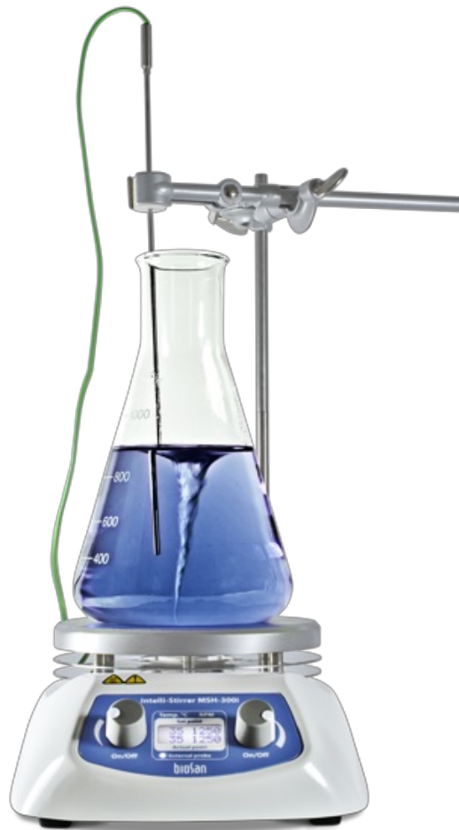
Intelli-Stirrer MSH-300i BS-010309-AAA Magnetrührer mit Heizplatte
