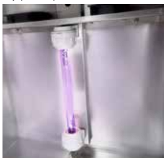
Система УФ-рециркуляции воздуха внутри камеры
