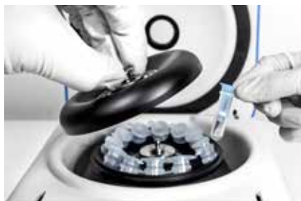
Защитная крышка для ротора
