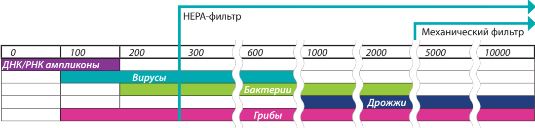
Рис. 2. Эффективность HEPA фильтрации относительно различных биологических объектов и их размеров, нм
