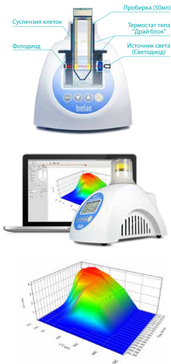
Рис. 1. 3D график кинетики роста E.coli BL21 показывающий эффект разных температур проведённых на 7 RTS биореакторах одновременно
