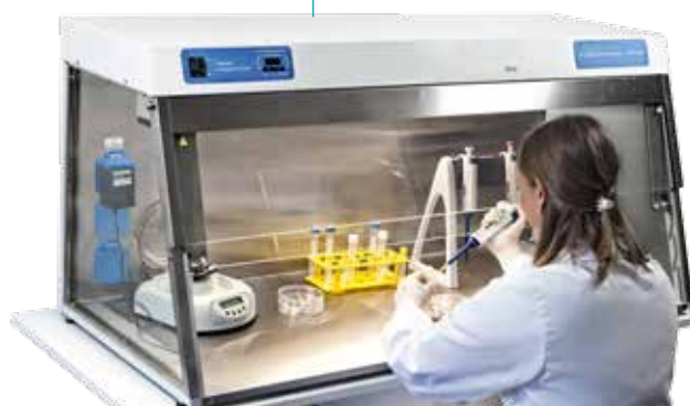
ПЦР-бокс UVT-S-AR с оборудованием для выделения нуклеиновых кислот
